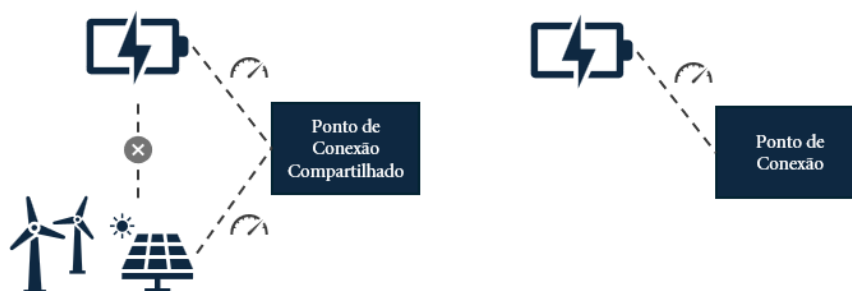
Figura 2 Configurações que exigem a outorga de Agente Armazenador (esquerda: SAEB Associado; direita: SAEB Autônomo)
