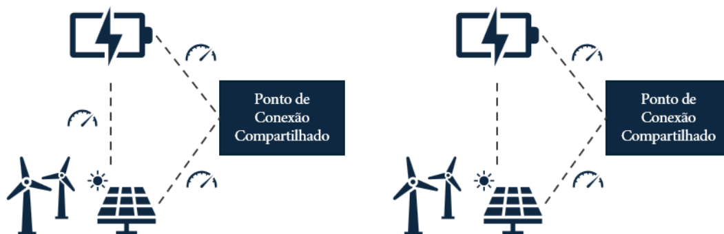
Figura 3 Configurações para Usinas de Geração com Armazenamento (SAEB Colocalizado): à esquerda, com medição individualizada para preservação de desconto da TUST/D; à direita, sem medição individualizada, sem desconto da TUST/D.)
